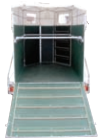
Rückwärtige Bordwand seitlich aufgehend oder als Aufstiegsrampe
