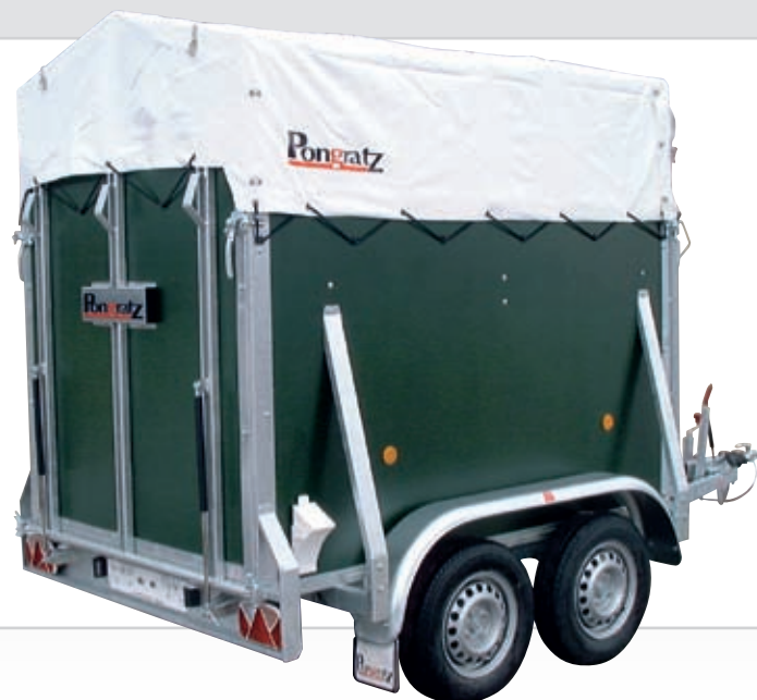
Abb.: Multifunktionsleuchte, Hebehilfe und Verschlusssystem für hintere Bordwand
