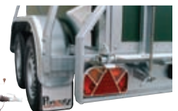
Abb.: Multifunktionsleuchte, Hebehilfe und Verschlusssystem für hintere Bordwand
